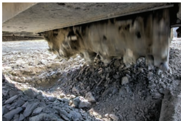
Herzstück der Maschine – Die rotierende Walze mit 58 Rundschaffmeisseln
