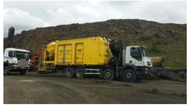
4 – Linien Injektionseinheit: ATLAS COPCO, UNIGROUT MAX 244C
