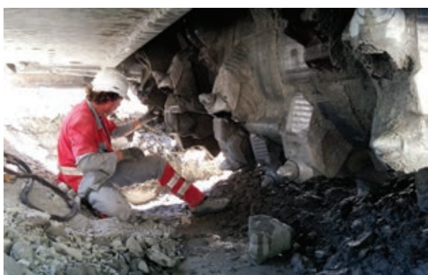
Der Meisselwechsel kann innerhalb weniger Minuten durchgeführt werden
