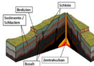
Die Geologie besteht hauptsächlich aus Lavaschichten (Basalt) zwischen denen Sedimentschichten und Schlackeablagerungen anzutreffen sind. Brekzien können sich in vertikalen Vulkanschlotten und Bruchzonen gebildet haben.
